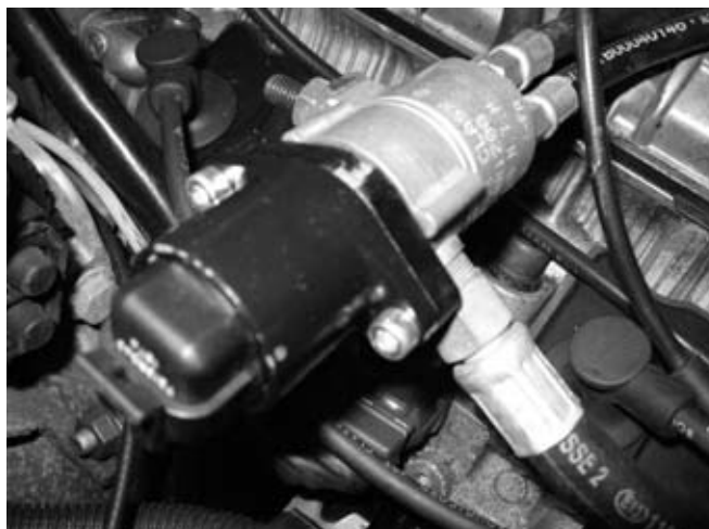
Rys. 3. Aktuator liniowy i zawór czwórdrożny paliwa wysokooktanowego Fig. 3. Linear Actuator and Four Way Valve of High Octane Fuel
